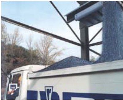
Chargement direct sur camion
