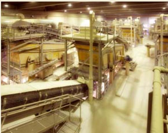
Optimierung der Siebauslastung über gravimetrische Aufgaberegulung
