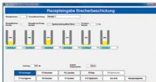
Rezepteingabemaske Brecherbeschickung mit Brecherparametern
